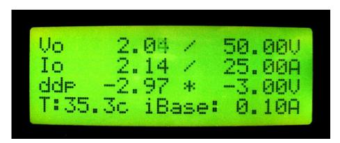
Sulla prima riga è visualizzata la tensione in uscita dell'alimentatore ed il limite impostato Sulla seconda riga è visualizzata la corrente in uscita dell'alimentatore ed il limite impostato Sulla terza riga è visualizzata la d.d.p. struttura-terreno ed il valore impostato della d.d.p. Sulla quarta riga è visualizzata la temperatura del modulo di regolazione ed il valore impostato della corrente di base
