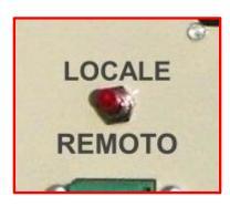
**Interruttore Locale / Remoto** per la disabilitazione della programmazione dell'apparecchiatura da remoto e l'abilitazione della programmazione da console locale..
