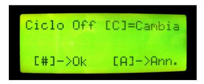
Digitando C si abilita / disabilita la modalità on- off e si entra nel menù di configurazione dei tempi
