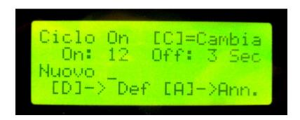
Per modificare i tempi si digitano: nuovo valore di On, asterisco, nuovo valore di Off Digitando **D** si confermano i valori visualizzati e si chiude il menù Digitando **A** si annullano tutte le modifiche e si chiude il menù
